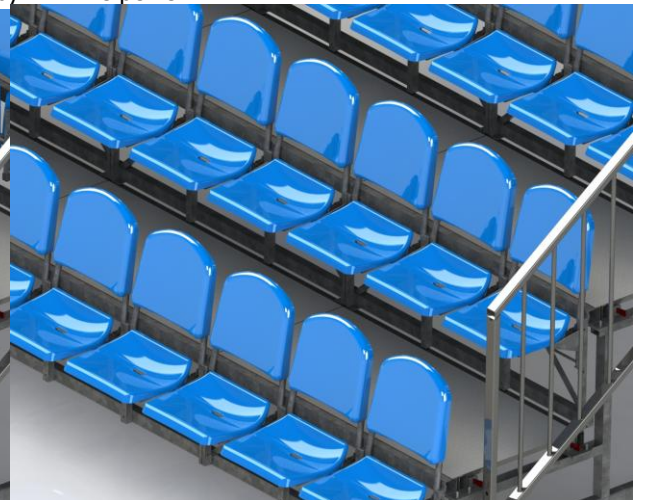
Поворотно-откидное сидение кресла позволило максимально сократить глубину ряда трибун (до 700мм), обеспечив при этом ширину проходов в рядах в соответствии с нормами пожарной безопасности (более 450мм)
