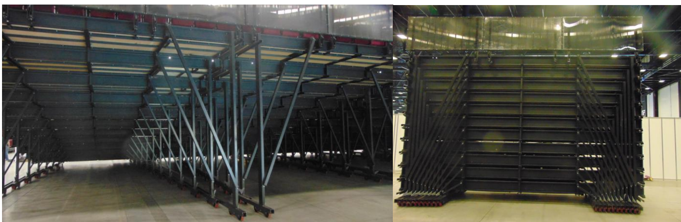
Рис. Механика трансформации телескопических трибун.
